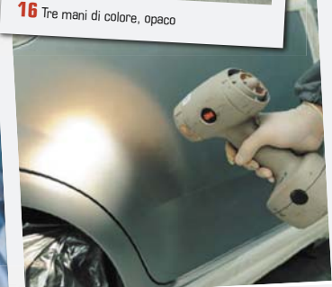
17 Controllo verniciatura con la lampada UV
